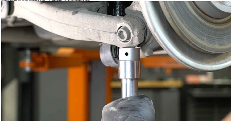
13 Draai het bevestigingsstuk dat de stabilisatorstang en de draagam met elkaar verbindt vast. Gebruik een combinatie steeksleutel Nr.16 Gebruik een dopsleutel Nr.16. Gebruik een momentsleutel. Draai deze vast tot een koppel van 40 Nm.+90°
