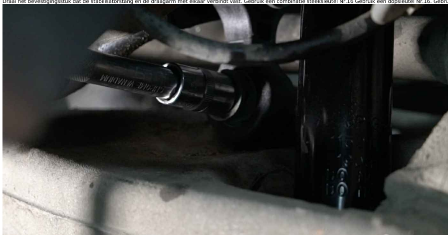
AUTODOC raadt aan: • Belangrijk! Zorg ervoor dat je nieuwe bevestigingen gebruikt. club.autodoc.be 6-10
