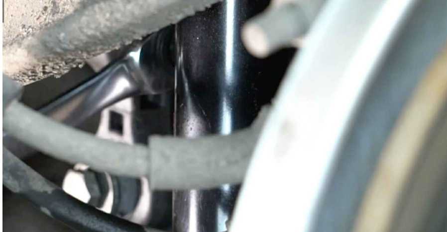
12 Ondersteun de arm. Gebruik een hydraulische versnellingsbak krik.
