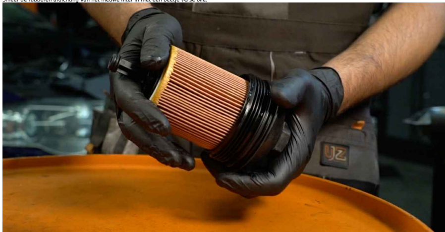
25 Smeer de rubberen afdichting van het nieuwe filter in met een beetje verse olie.
