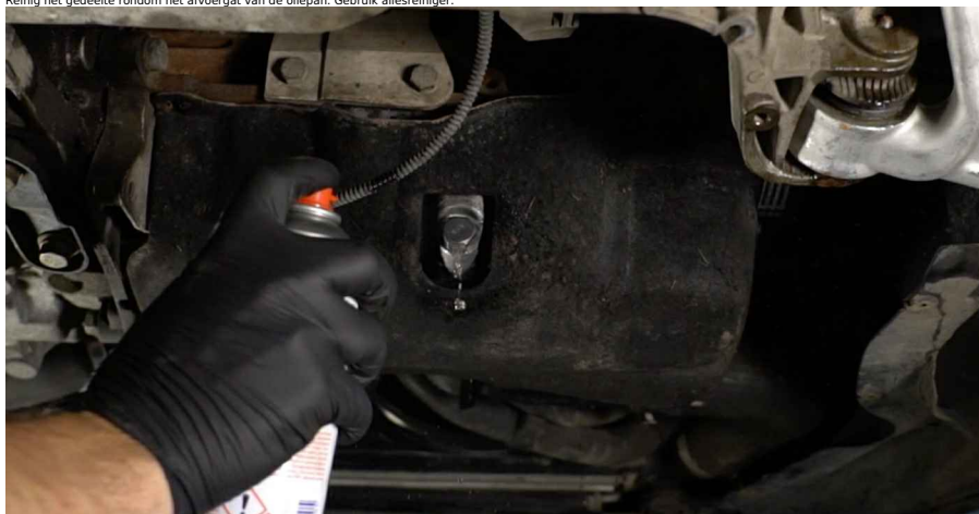
21 Reinig het gedeelte rondom het afvoergat van de oliepan. Gebruik allesreiniger.
