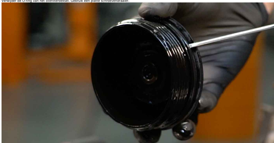
18 Reinig de kap van de oliefilterbehuizing. Gebruik allesreiniger.
