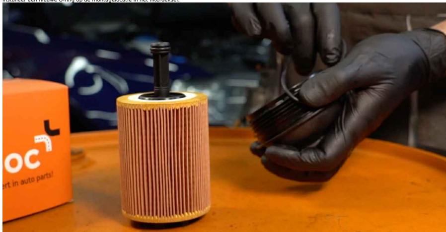
24 Installeer de nieuwe oliefilter in de montagelocatie op het filterdeksel.
