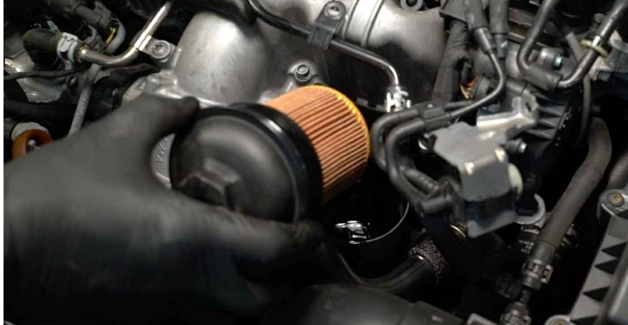
27 Installeer een nieuw deksel op de oliefilterbehuizing en span deze aan. Gebruik een dopsleutel Nr.32. Gebruik een momentsleutel. Draai deze vast tot een koppel van 25 Nm.
