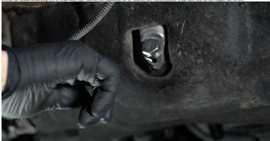
21 Reinig het gedeelte rondom het afvoergat van de oliepan. Gebruik allesreiniger.
