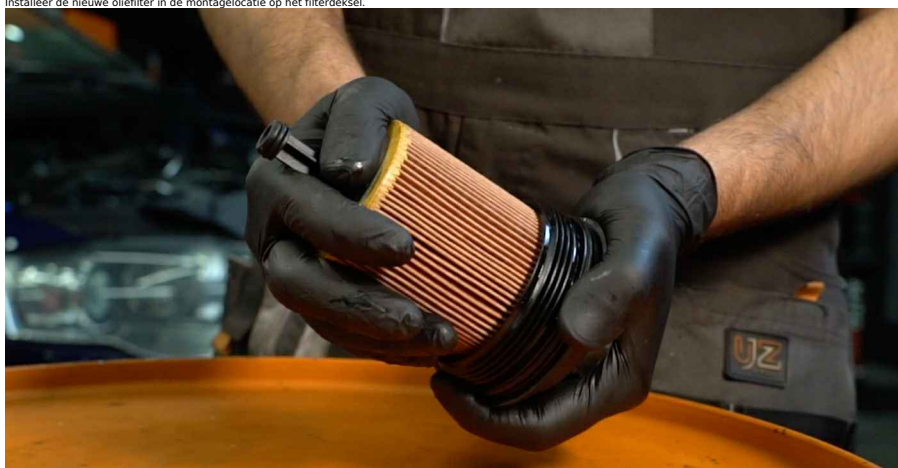
Let op! • Zorg ervoor dat de filter correct geïnstalleerd wordt. Verwissel de zijden van het onderdeel niet.
