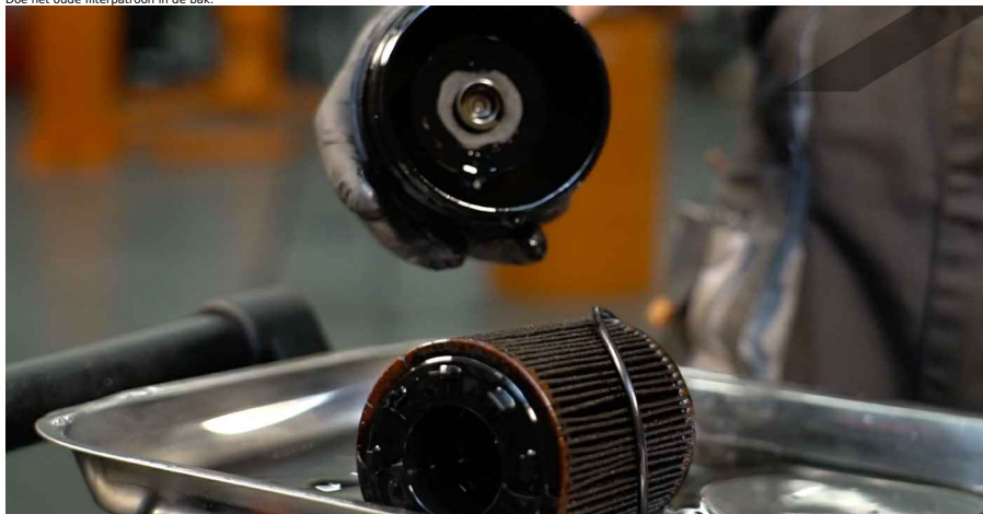
16 Maak de oliefilter los van het filterdeksel.
