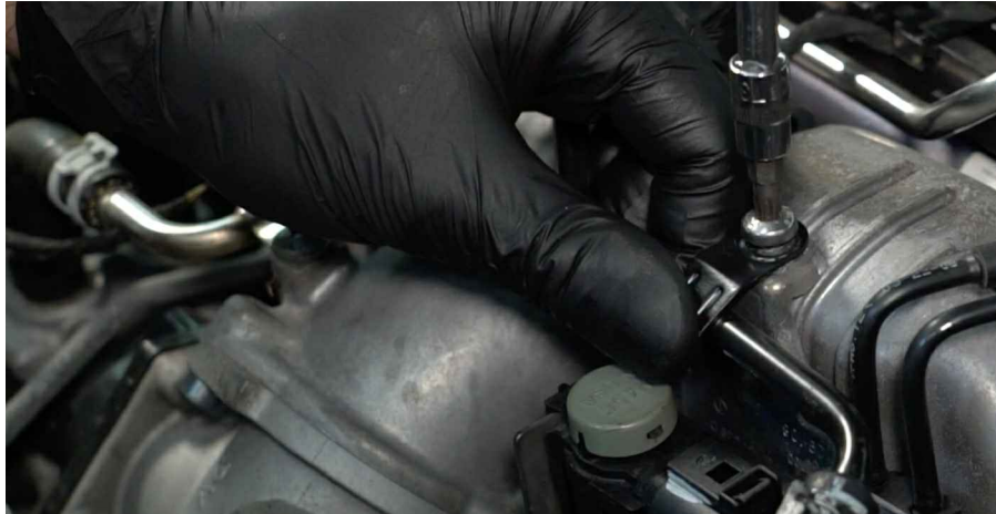
30 Installeer het motordeksel en maak het vast.
