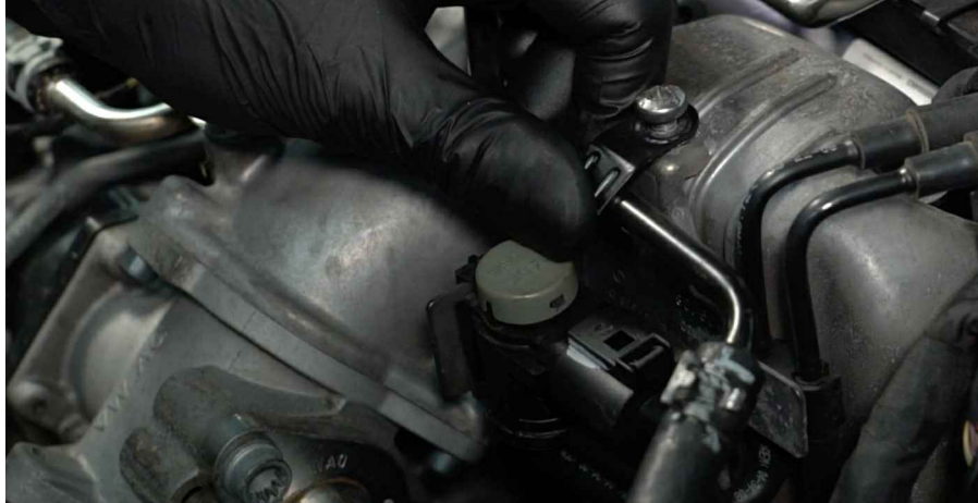
29 Schroef de steun van de vacuüminstallatie in. Gebruik Torx T20. Gebruik een ratsleutel.
