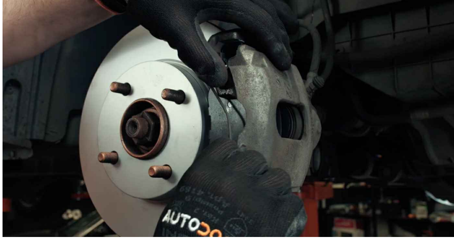
28 Behandel het oppervlak waar de remschijf contact maakt met de velg. Gebruik een kopersmeermiddel.
