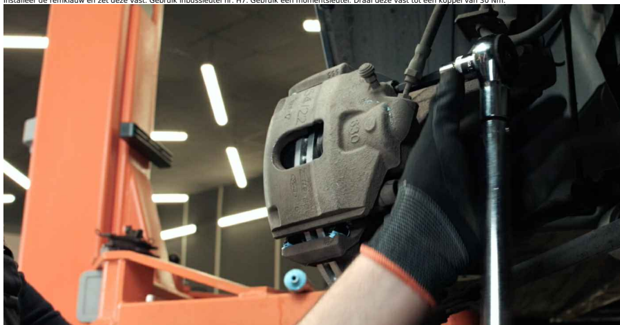
26 Installeer de stofkappen op de geleidepennen van de remklauw.
