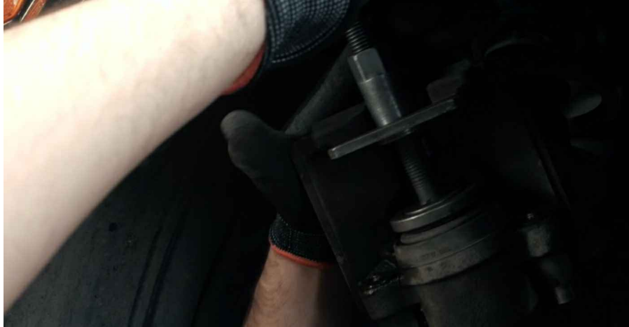
24 Installeer de remblokken.
