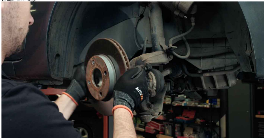
17 Reinig de remklauwbeugel van vuil en stof. Gebruik een staalborstel. Gebruik een remmenreiniger.
