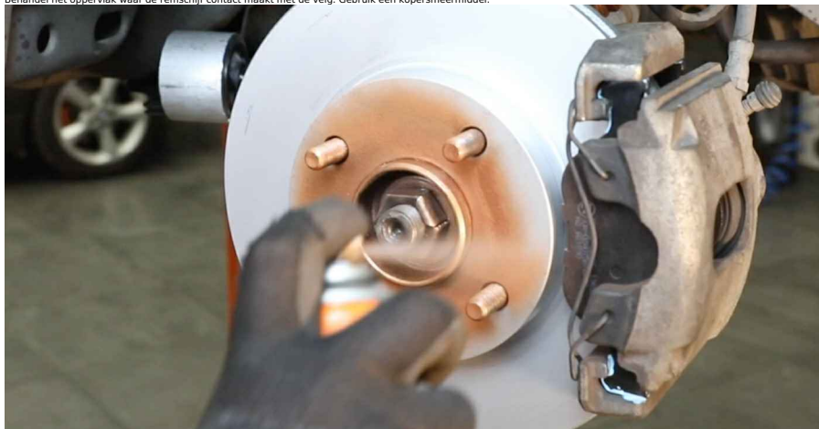
29 Reinig het oppervlak van de remschijf. Gebruik een remmenreiniger.
