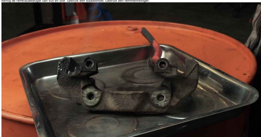
17 Reinig de remklauwbeugel van vuil en stof. Gebruik een staalborstel. Gebruik een remmenreiniger.
