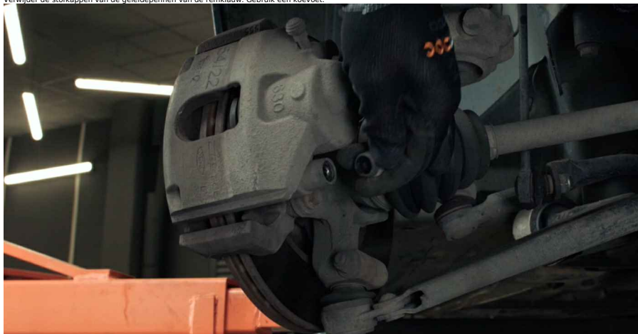
9 Schroef de bevestiging van de remklauw los. Gebruik inbusseutel nr. H7. Gebruik een ratelsleutel.
