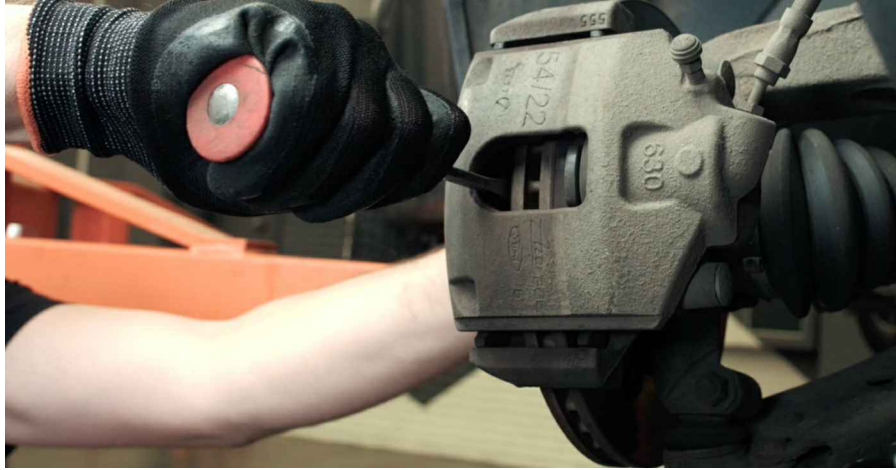
8 Verwijder de stofkappen van de geleidepennen van de remklauw. Gebruik een koevoet.
