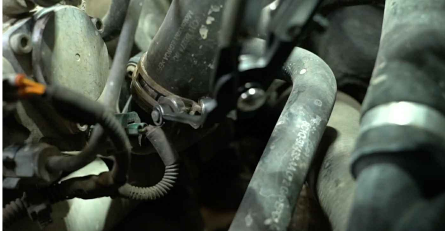
10 Maak de koelvloeistofslang los en sluit hem af met een papieren handdoek.
