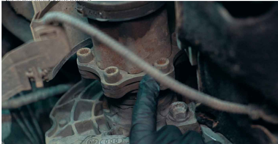
De experts van AUTODOC bevelen aan: • Houd de aandrijfas op zijn plaats om te voorkomen dat hij draait
