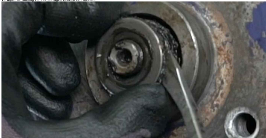
10 Verwijder het wielager. Gebruik een koevoet.
