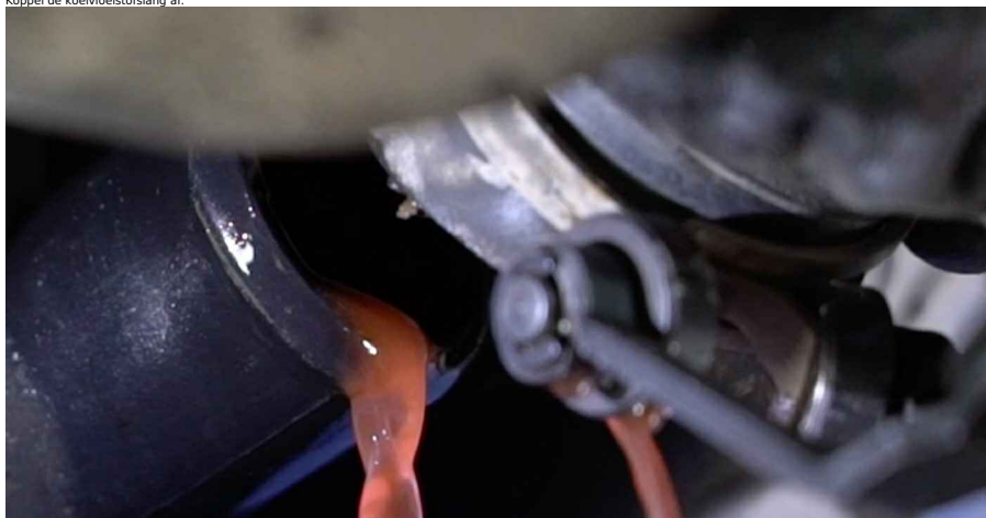
8 Koppel de koelvloeistofslang af.
