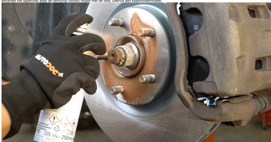
16 Reinig het oppervlak van de remschijf. Gebruik een remmenreiniger.
