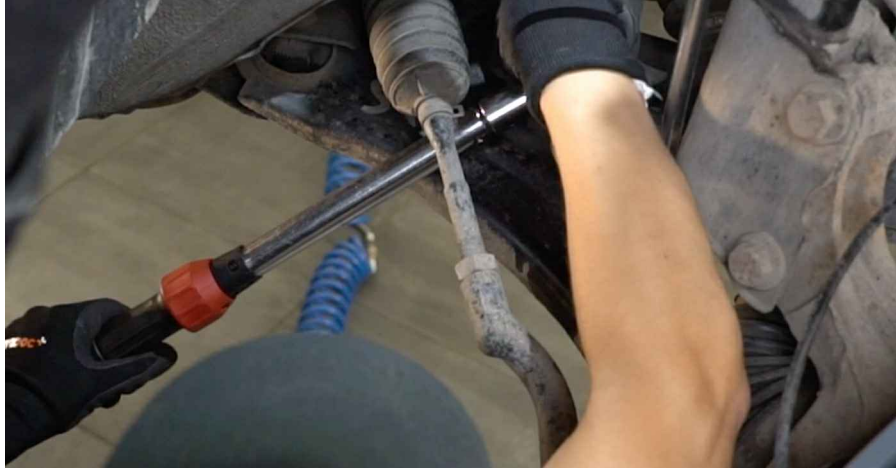
13 Draai het bevestigingsstuk dat de koppelstang en de veerpoot met elkaar verbindt vast. Gebruik een combinatie steeksleutel Nr.19 Gebruik een dopsleutel Nr.19. Gebruik een momentsleutel. Draai deze vast tot een koppel van 65 Nm.
