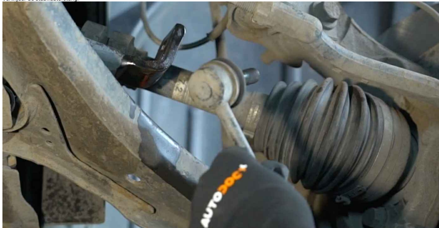
Vervanging: stabilisatorstang - RENAULT KOLEOS (HY ), AUTODOC beveelt aan: • Inspecteer de stabilisatorbussen. Vervang ze indien nodig.
