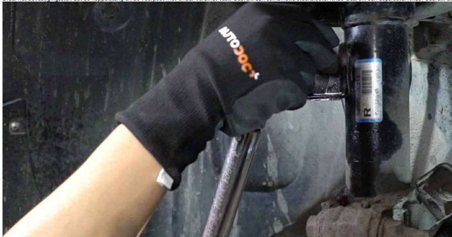
14 Behandel alle gewrichten van de koppelstang. Gebruik een kopersmeermiddel.
