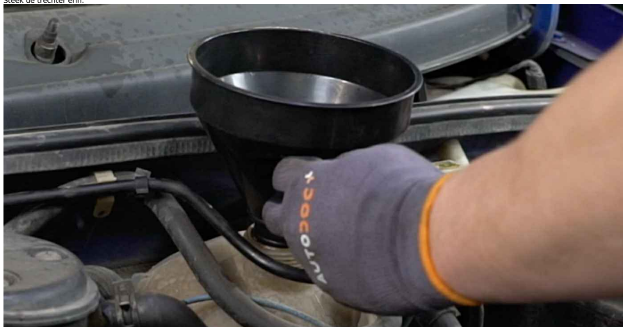
35 Vul het expansiereservoir met koelvloeistof.
