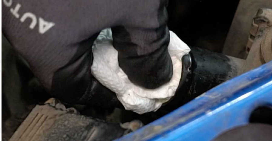
19 Maak het thermostaathuis schoon. Gebruik een staalborstel. Gebruik allesreiniger.
