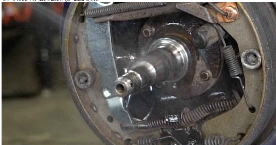
24 Plaats de remtrommel die samengevoegd is met de wiellager.
