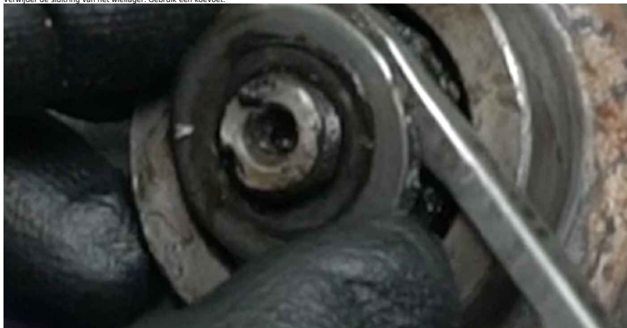
10 Verwijder het wiellager. Gebruik een koevoet.
