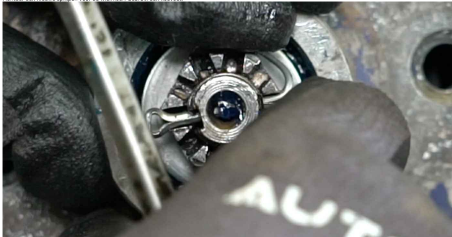
34 Installeer de kap van de naafmoer. Gebruik een rubberen hamer.
