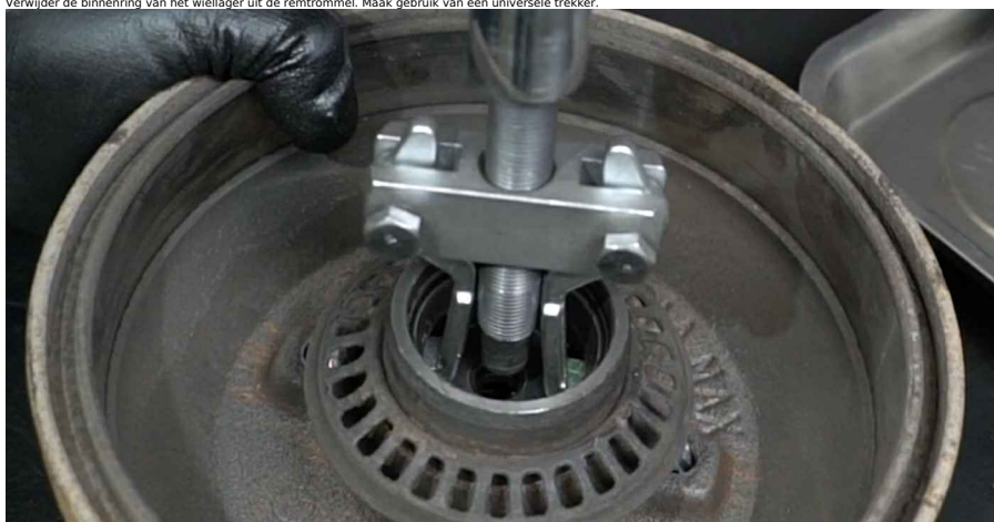
15 Verwijder de binnenring van het wiellager uit de remtrommel. Maak gebruik van een universele trekker.
