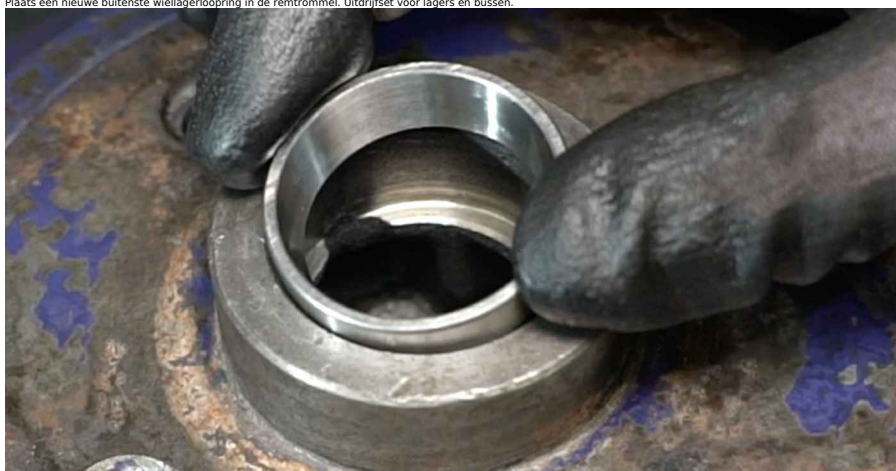
19 Plaats de nieuwe binnenring van het wiellager in de remtrommel. Uldrijfset voor lagere en bussen.
