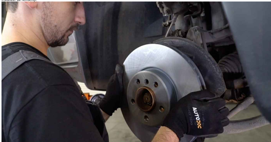
24 Span de bevestiging van de remschijf aan. Gebruik Torx T30. Gebruik een momentsleutel. Draai deze vast tot een koppel van 16 Nm.
