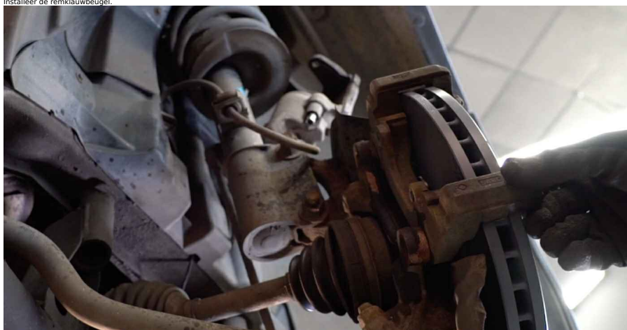
26 Span de remklauwbeugel aan. Gebruik een dopsleutel Nr.16. Gebruik een momentsleutel. Draai deze vast tot een koppel van 110 Nm.
